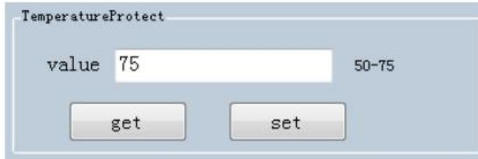
图 14 设置保护温度
